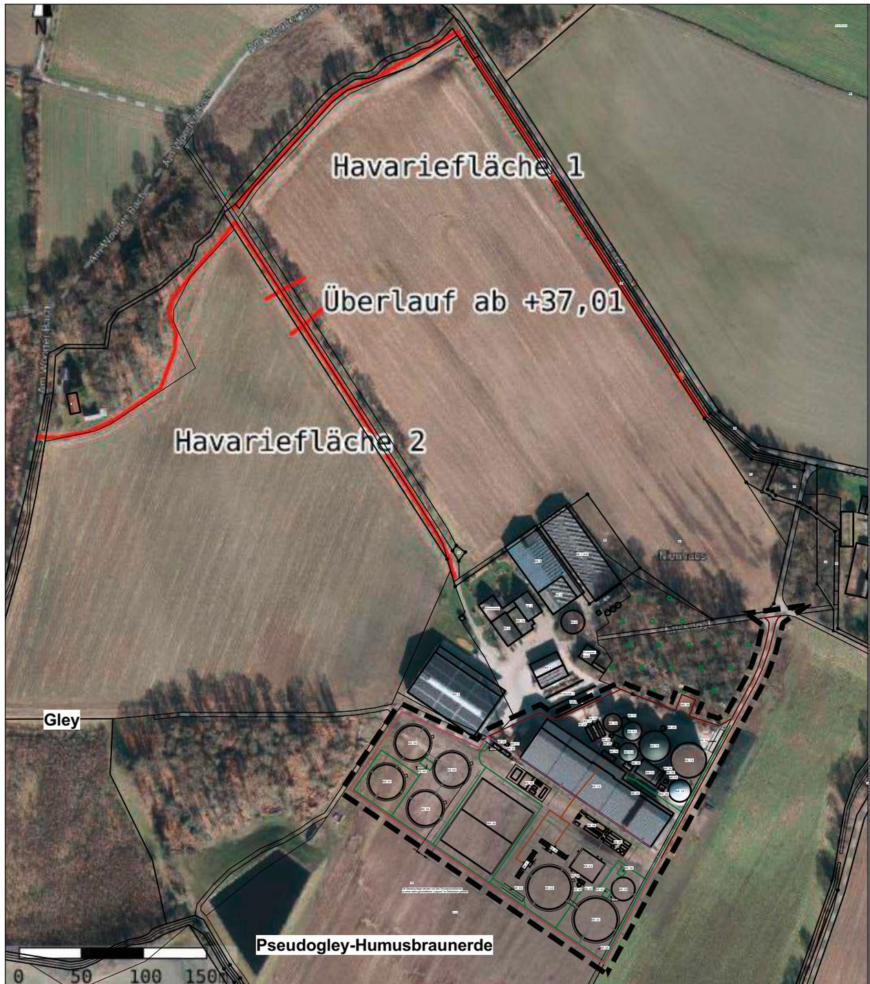
Abb. 3: Lage der Flächen für das Auffangvolumen im Havariefall
